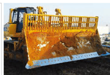
Отвал для утилизации отходов
