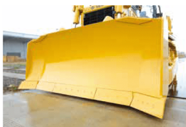
Полууниверсальный отвал (с гидроцилиндром наклона)
